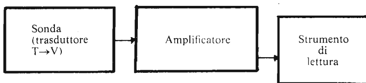
Figura 1 - Schema a blocchi di un termometro elettronico.
